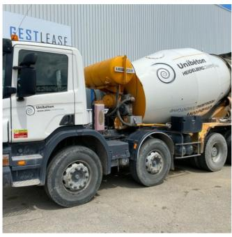
Nouveauté ?: Oui Référence : FF378HP Marque: **SCANIA** Modèle: P 380 Date de P.M.E.C: 21/02/2008 Numéro de série : VLUP8X40009128400 Kilomètres au compteur : 235 366 Automatique Type de boîte : Puissance: 380 Ch Norme pollution: Euro 4 Carrosserie: Toupie / Malaxeur Formules des roues : 8x4 P.V: 13,40 t P.T.A.C: 32,00 t P.T.R.A: 35,50 t
